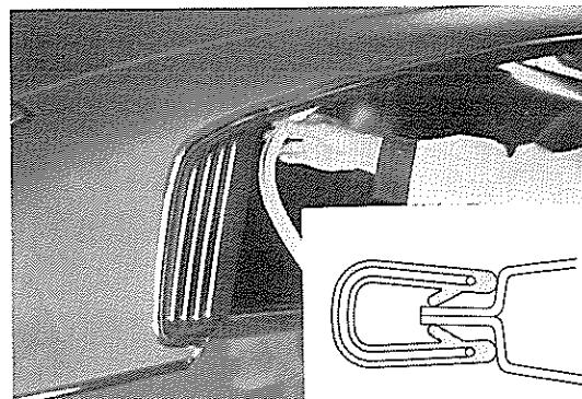
第17-198図 ドア オープニング モールディング取りはずし C0201 G8894
